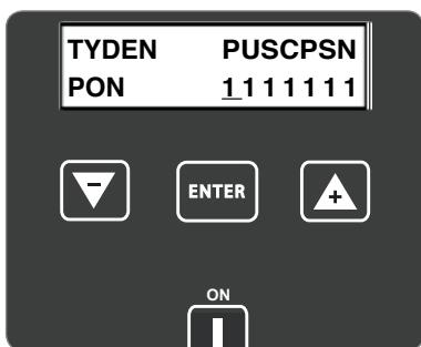
**PRACOVNI DOBA 1:** Funkce pro nastavení prvního hodinového pásma provozu robotické sekačky během dne.
