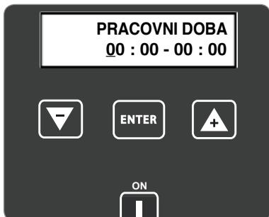
**PRACOVNI DOBA 2:** Funkce pro nastavení druhého hodinového pásma provozu robotické sekačky během dne.
