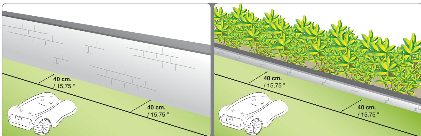
Když se uvnitř nebo zvenčí pracovní plochy nachází záhon, živý plot, rostlina s přečnívajícími kořeny, malý příkop (2-3 cm) nebo malý obrubník (2-3 cm), položte obvodový drát do vzdálenosti nejméně 40 cm (15,75"), aby se zabránilo poškození robotické sekačky nebo přítomných překážek. Sekání případné trávy na ploše, na které jste se rozhodli neumožnit činnost robotické sekačky, bude možné provést s použitím ořezávače okrajů trávníku nebo křivonořezu.
