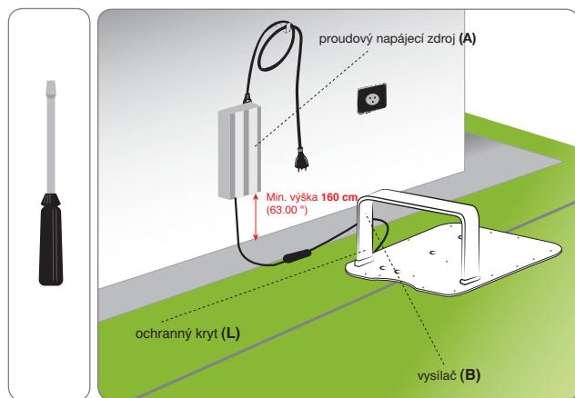
1. Proveďte instalaci napájecího zdroje (A).
