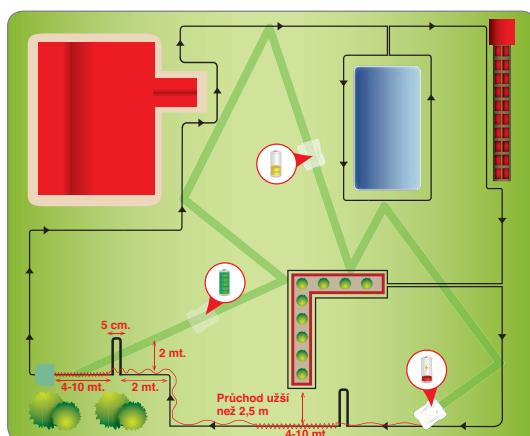
„Přivolání podél drátu“ informuje robotickou sekačku nejen o tom, že se nacházíme v blízkosti nabíjecí stanice, ale také o úzkém průchodu nebo o šípce pro rychlý návrat do nabíjecí stanice. Bezprostředně po rozeznání signálu „Přivolání“ bude robotická sekačka sledovat obvodový drát nízkou rychlosťí a s vyšší přesnosti na úseku přibližně 10 m (33') a poté se vrátí do režimu návratu „V-Meter“, pokud dříve nenarazí na nabíjecí stanici nebo na rychlý návrat.
