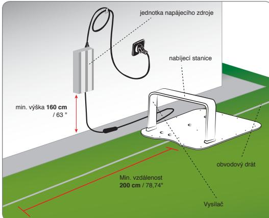
V případě instalace robotické sekačky do blízkosti prostoru, ve kterém je nainstalována jiná robotická sekačka (stejná nebo od jiného výrobce) bude třeba ve fázi instalace provést změnu na vysílači a přijímači robotické sekačky, aby se frekvence obou robotických sekaček vzájemně nerušily.
