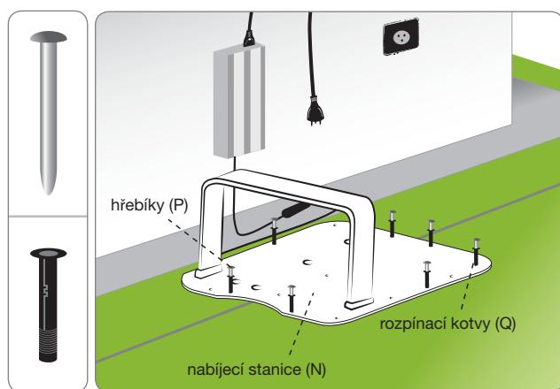
7. Připojte napájecí kabel (E) nabíjecí stanice (N) k napájecímu zdroji (A).
